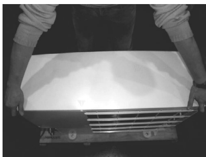
déclipser aux deux extrémités
